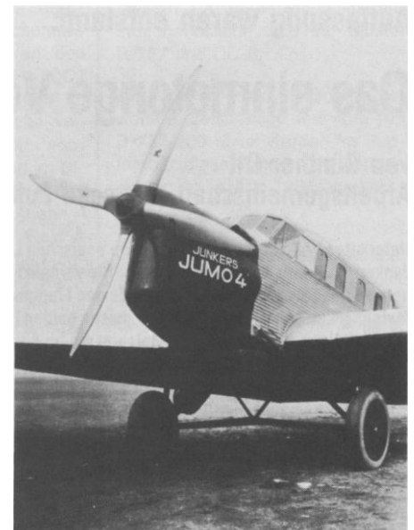
Mit der D-2175, dem zweiten Versuchsträger der Junkers-Werke, wurde der JuMo 4-Dieselmotor erprobt. (Foto: Sammlung Ott)
